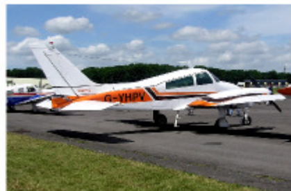
Fig.C.9: Cessna 310N: 60 kWh pro 100 p-km. Eine Cessna 310 Turbo befördert 6 Passagiere (inkl. Pilot) mit einer Geschwindigkeit von 370 km/h. Foto von Adrian Pingstone.
