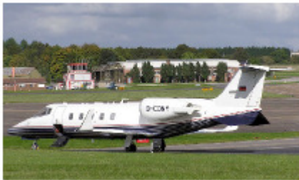
Fig.C.10: „Legen Sie Ihre Sicherheits-Manschettknöpfe an!“ Ein Bombardier Learjet 60XR befördert 8 Passagiere mit 780 km/h bei Transportkosten von 150 kWh pro 100 p-km. Foto von Adrian Pingstone.
