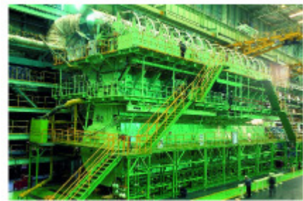
Fig.A.15: Der Wartsila-Sulzer RTA96-C 14-Zylinder Zweitakt-Dieselmotor. 27 m lang und 13,5 m hoch. www.wartsila.com
