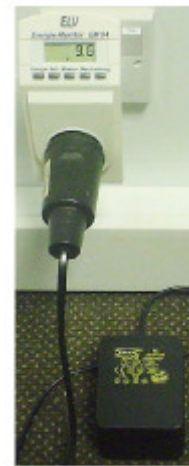
Fig.22.1: Ein schrecklicher Trafoadapter einer Ikea-Lampe, der Adapter verbraucht fast 10 W wenn die Lampe aus ist!
