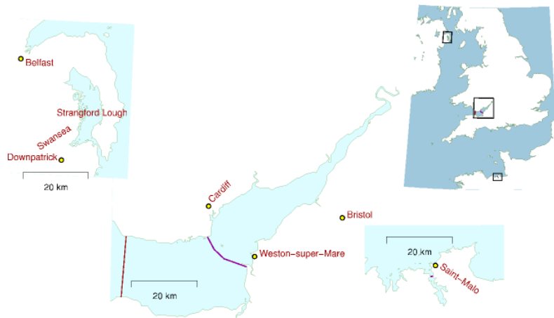
Fig.14.8: Das geplante Severn Stauwerk (unten links) und Strangford Lough in Nordirland (oben links) im Maßstabsvergleich mit dem Stauwerk bei La Rance (unten rechts). Die Karte zeigt zwei mögliche Stellen für das Severn-Stauwerk. Die Variante bei Weston-super-Mare würde im Mittel 2 GW (0,8 kWh/d/p) liefern, die äußere Variante doppelt so viel.
