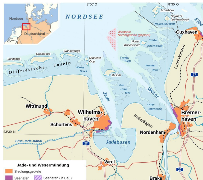
Fig. 14.7a: Der Jadebusen bei Wilhelmshaven. Bei 3,70 \text{ m} Tidenhub könnte er über ein Sperrwerk mit seinen 200 \text{ km}^2 Seefläche bis zu 600 \text{ MW} Gezeitenleistung liefern. (Karte: Wikipedia, Urheber Alexander Karnstedt, Creative Common Lizenz).
