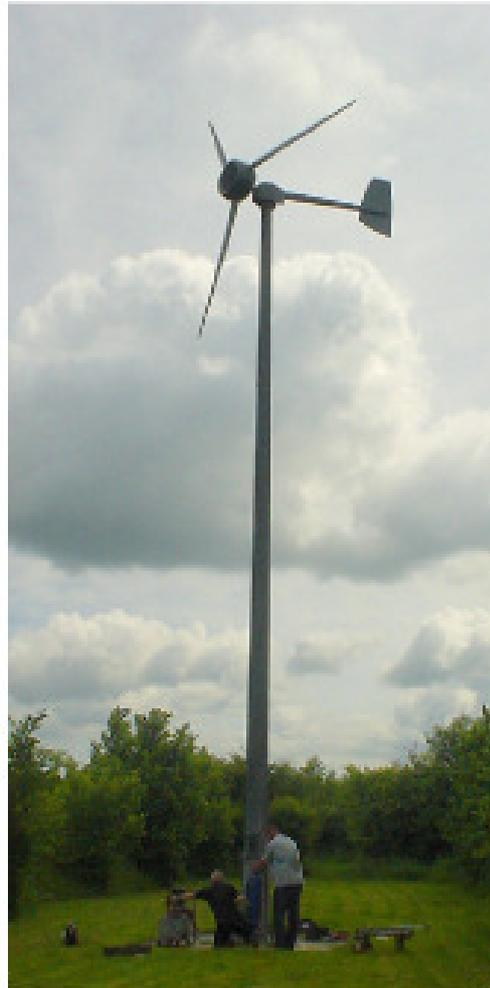
Fig.B.10: Eine Iskra 5 kW Turbine mit 5,5 m Durchmesser [www.iskrawind.com] bei der jährlichen Wartung. Diese Turbine steht in Hertfordshire (nicht einer der windigsten Orte in England) in 12 m Höhe und hat einen mittleren Leistungs-Output von 11 kWh pro Tag. Eine Windfarm mit Maschinen dieser Performance, je eine auf 30 m x 30 m, hätte eine Energiedichte pro Flächeneinheit von 0,5 W/m<sup>2</sup>.
