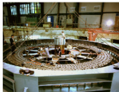
Fig.26.15: eines der beiden Schwungräder an der Fusionsforschungsstätte Culham, in Bau. Foto EFDA-JET. www.jet.efda.org
