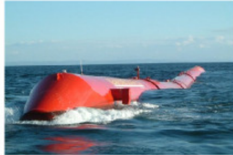
Fig.12.1: Ein Pelamis Wellenenergie-Kollektor ist eine Seeschlange mit vier Sektionen. Er wird mit der Nase in Richtung der einlaufenden Wellen ausgerichtet. Die Wellen biegen die Schlange, und diese Bewegungen treiben hydraulische Generatoren. Die Spitzenleistung einer Schlange ist 750 kW. In bester Atlantiklage könnte eine Schlange 300 kW mittlere Leistung abgeben. Foto von Pelamis Wave Power www.pelamiswave.com
