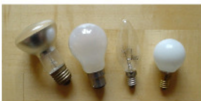
Fig.2.1: Unterscheidung von Energie und Leistung: Jede dieser 60 Watt-Lampen hat 60 Watt Leistung, wenn sie an ist; sie hat nicht eine „Energie“ von 60 W. Sie benutzt 60 W elektrischer Leistung und emittiert 60 W Leistung in Form von Licht und Wärme (hauptsächlich letzteres).
